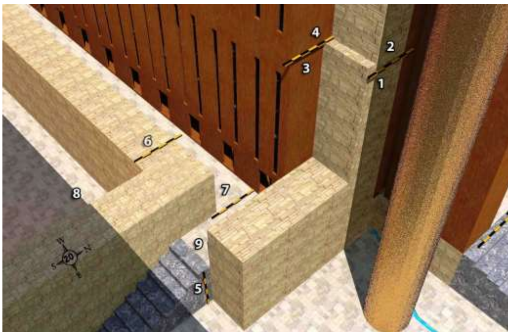
Рис. #20. Юго-восточный угол Храма. -№1. Стена Храма в шесть локтей. №2. Более узкая стена Храма, в пять локтей. №3. Боковые помещения в 4 локтя. №4. Более широкие боковые помещения в пять локтей. №5. Фундамент Храма (6 локтей). №6 Наружная стена(5 локтей шириной). №7. Проход по сторонам Храма – 5 локтей. №8. "Отдельное пространство" в 20 локтей. №9. Южная дверь к боковым помещениям.
